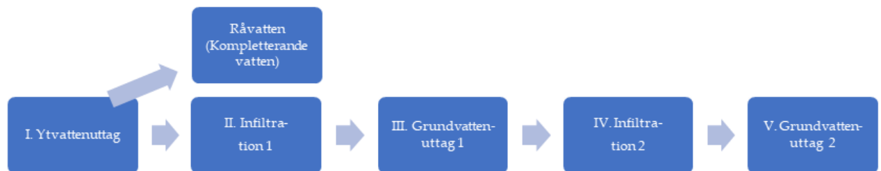
Figur 19. Flödesschema över de vattenuttags- och infiltrationssteg som utgör vattenverksamhet.
